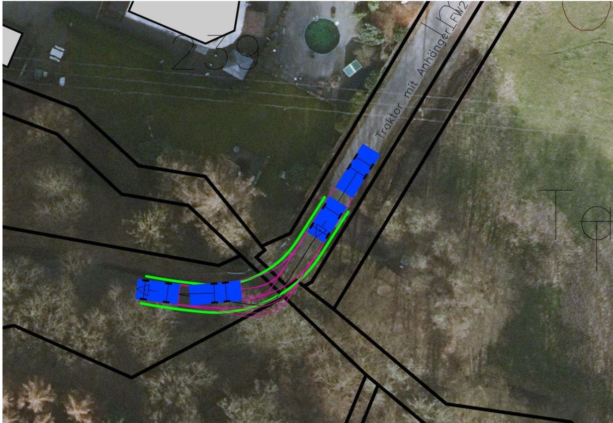
Abb. 10: Schleppkurve – Traktor mit Anhänger -Istzustand
