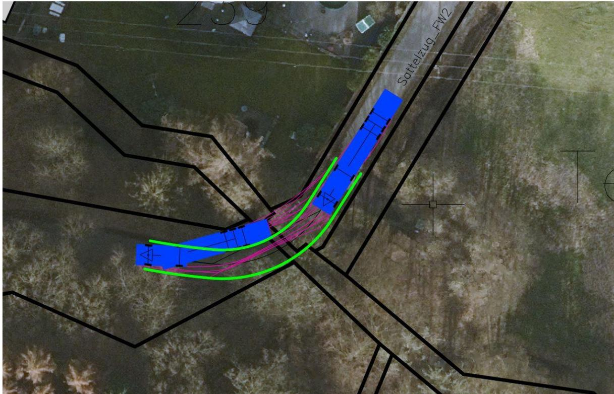
Abb. 11: Schleppkurve – Sattelzug -Istzustand (Quelle: eigene Darstellung)
